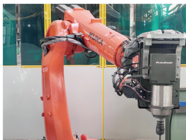
実証試験中の「溶接補修ロボット」
