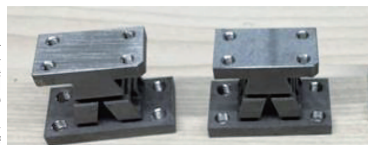
採用された低熱膨張合金の3Dプリンター品
