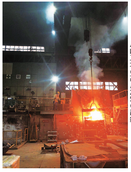
川崎工場の高周波炉の出鋼
