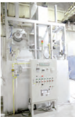
3Dプリンターと連動する乾燥炉
