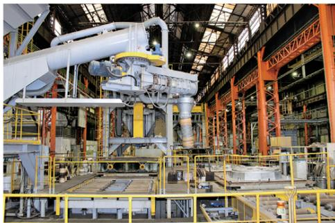
世界最大級の金枠サイズの半自動造型ライン
