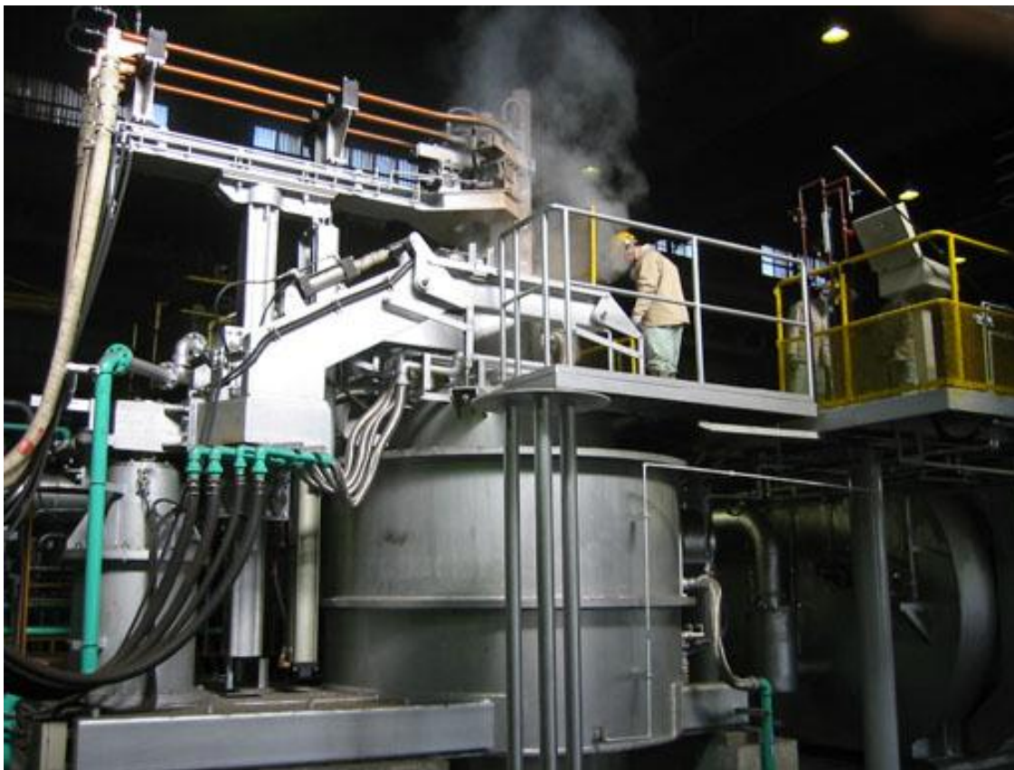
溶鋼を特殊処理する真空脱ガス設備
